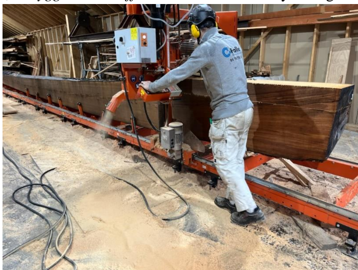
Tilskæring af vingearmene sker med en voksen sav
